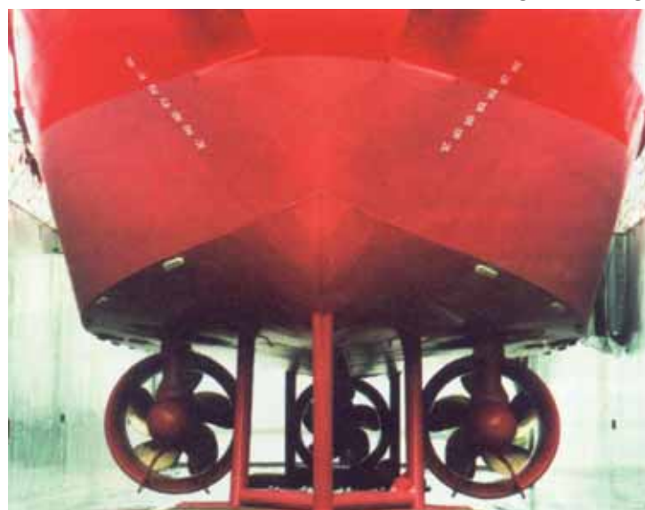
Penataan Z-drives yang unik pada Rotor tug, dua di bagian depan dan satu di bagian belakang.
