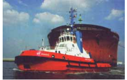
Kelincahan yang lebih baik dari Rotor tug membuat lebih mudah untuk menangani kegiatan tunda kapal.
