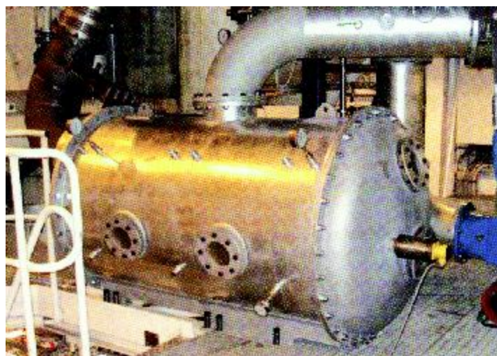
Gambar 7: Scrubber EGR yang baru dikembangkan oleh MAN Diesel dipasang pada sebuah mesin untuk keperluan pengetesan.
