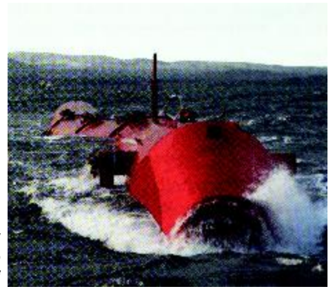
Sebuah pembangkit energi ombak dari Pelamis Wave Energy sedang beroperasi
