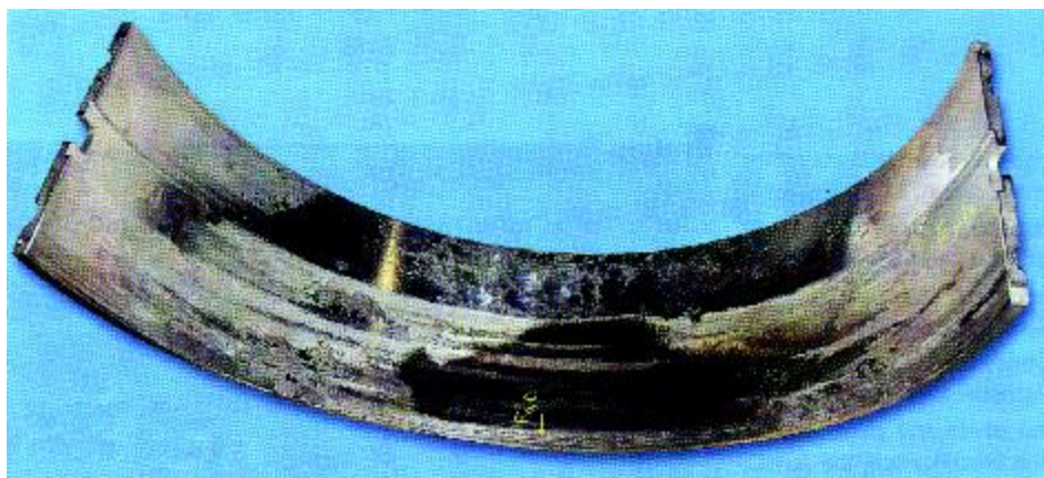
Gbr 3. Kerusakan metal duduk bantalan poros utama sebuah mesin bisa memakan biaya sampai ribuan dollar
