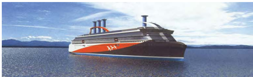
Sebuah kapal feri jenis cruiser yang menggunakan empat rotor Flettner untuk penggerak kapal dengan tiga unit menyatu pada cerobong asap dan satu unit menyatu pada tiang depan kapal
