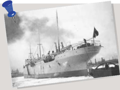
Kapal “ Selandia ” milik perusahaan pelayaran East Asiatic , tahun 1912, umumnya dianggap sebagai kapal untuk pelayaran samudera pertama yang menggunakan mesin diesel.
