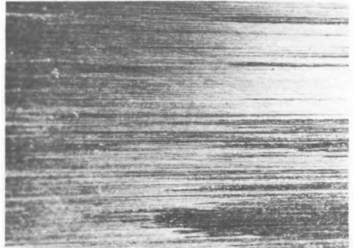
Gambar 12. Lubang-lubang / bopeng pada permukaan metal yang disebabkan oleh pelepasan muatan listrik ( electrical discharge ).
