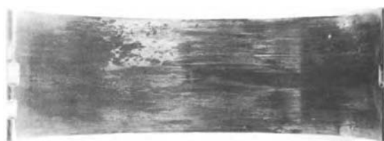
Gambar 6. Kerusakan akibat metal meleleh karena overheating kemudian tersapu ( wiping damage ).
