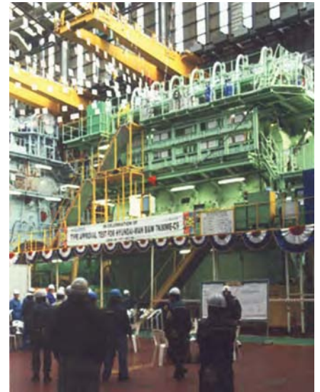
Gambar sebuah mesin diesel MAN 7K80ME-C9 dari jenis MARK 9 yang pertama, sedang menjalani pengujian untuk Type Approval di pabrik mesin Hyundai Heavy Industries di Ulsan – Korea.
